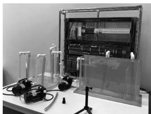
Рис. 4. Установка физического подобиия двухфазного сепаратора скважной жидкости
