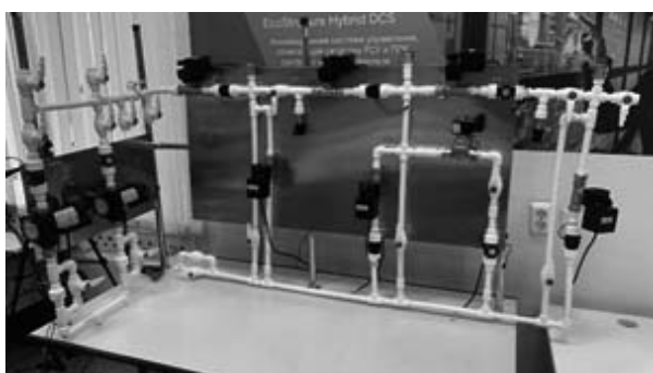
Рис. 3. Установка физического подобиия для исследования сложных гидропневматических систем
