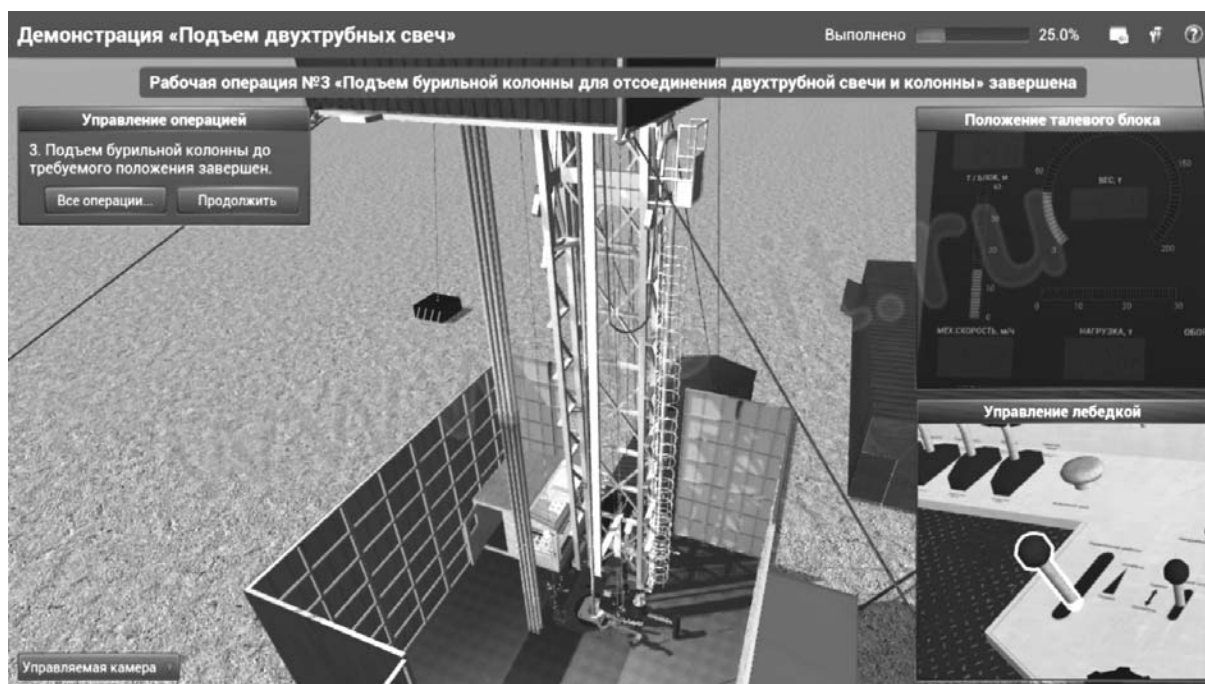
Рис. 2. Демонстрация «Подъем двухтрубных буровых свеч» в VR
