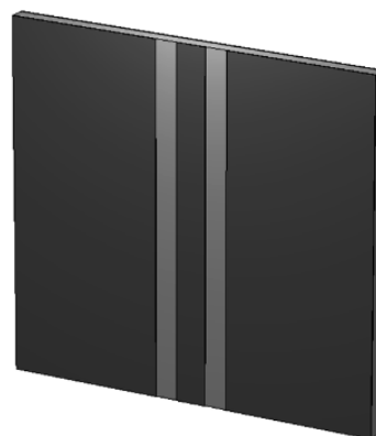
Рис. 3. Модель копланарной линии передачи для соединения печатных плат
