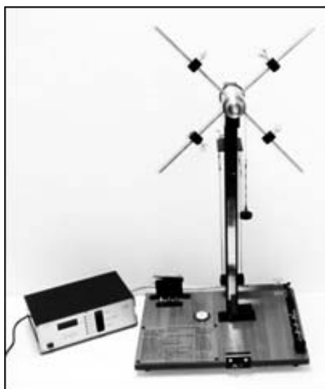
Рис. 1. Лабораторная установка «Маятник Обербека»
