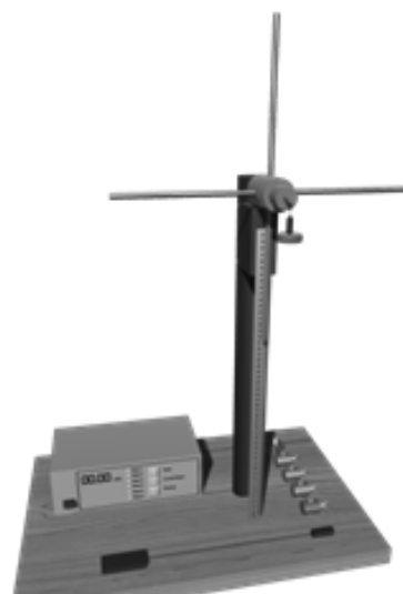
Рис. 2. 3D-визуализация виртуальной установки «Маятник Обербека»
